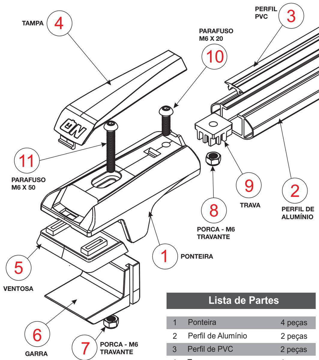
Para soltar as travessas empurre com uma chave de fenda as trava das **TAMPAS** (4) para acessar os **PARAFUSOS** (10 e 11)
