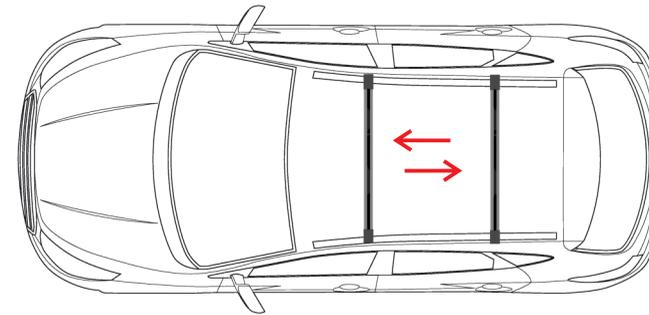
Regule a posição das travessas nas longarinas de acordo com a sua necessidade para o transporte da carga.
